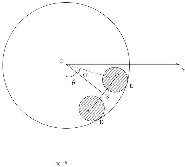
Si fissi il sistema di riferimento  $Oxyz$  con origine nel centro della guida circolare ed assi  $x, y$  nel piano del moto (vedi figura). Utilizzando come coordinata l'angolo  $\theta$  tra l'asse  $x$  e la direzione individuata dal segmento  $\overline{BO}$ , dove  $B$  è il punto medio dell'asta, scrivere l'equazione del moto attraverso le equazioni cardinali.
